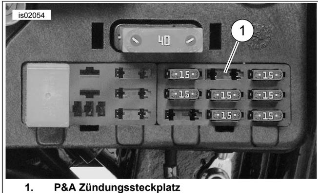
Abbildung 9. Buchse für 2-A-Sicherung (2004 FXDWG abgebildet)
