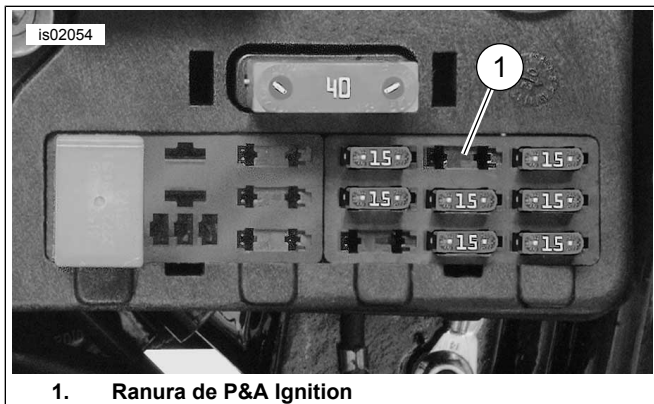
Figura 9. Enchufe para fusible de 2 A (se muestra el modelo FXDWG 2004)
