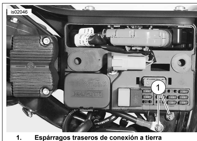
Figura 1. Conexión a tierra del modelo FXDWG 2004
