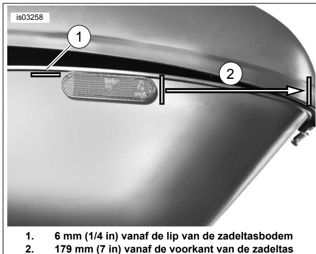
Afbeelding 16. Monteren van de reflector op de zadeltas
