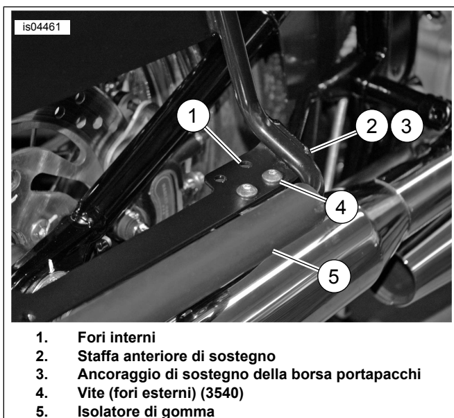
Figura 12. Installazione della staffa anteriore di sostegno sull'ancoraggio di sostegno della borsa portapacchi
