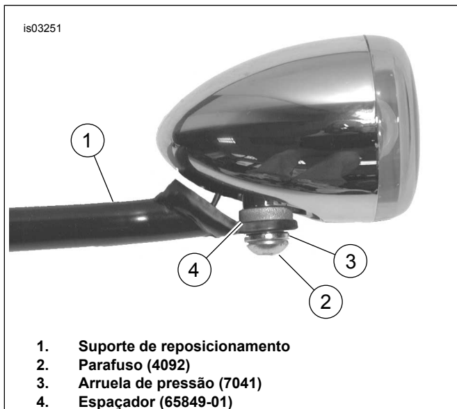
Figura 8. Instalação dos pisca-pisca de 2-3/8 pol.
