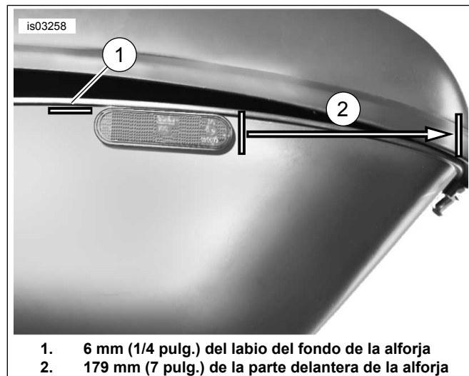
Figura 16. Instalación del reflector en la alforja
