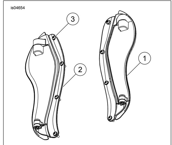
Figura 2. Parti di ricambio: Kit deflettori dell'aria regolabili
