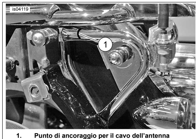
Figura 5. Punto di ancoraggio per il cavo dell'antenna sulla staffa
