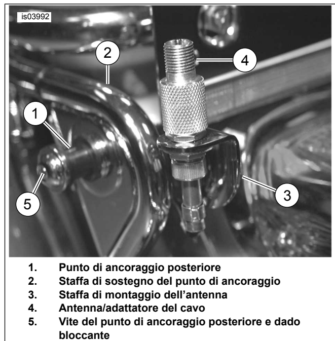
Figura 3. Staffa dell'antenna e cavo riposizionati
