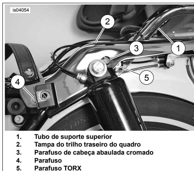
Figura 1. Remoção do tubo de suporte superior
