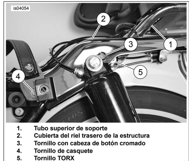
Figura 1. Extracción del tubo superior de soporte
