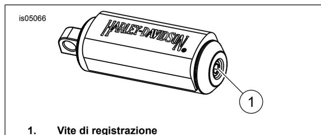
Figura 1. Vite di registrazione della pedalina poggia piedi
