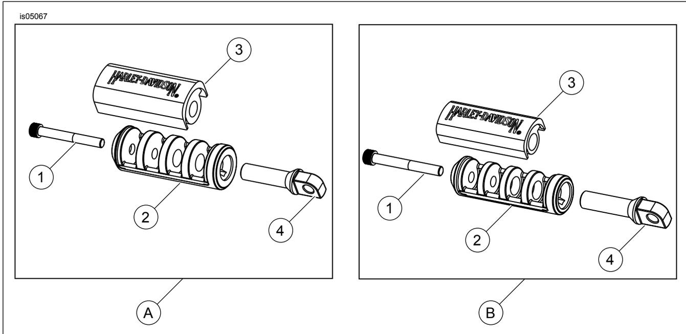
Figura 3. Parti di ricambio: kit pedalino della leva del selettore delle marce personalizzato
