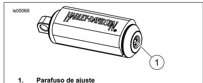
Figura 1. Parafuso de ajuste do pedal de apoio
