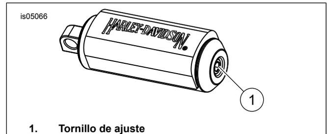
Figura 1. Tornillo de montaje del taco apoyapiés
