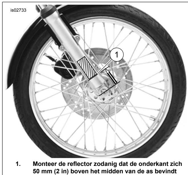
Afbeelding 2. Plaatsen van de reflector
