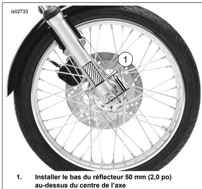
1. Installer le bas du réflecteur 50 mm (2,0 po) au-dessus du centre de l'axe
