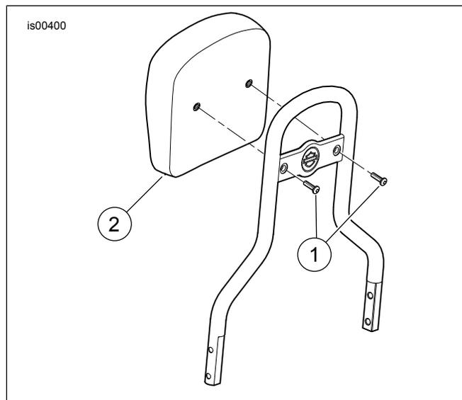
Figure 1. Pièces détachées : kits de coussin d'appui-dos FL
