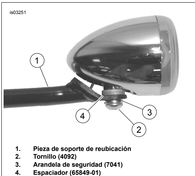
Figura 8. Instalación de señales de giro de 2-3/8 pulg.
