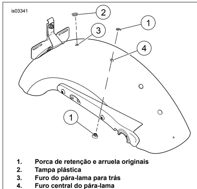
Figura 1. Localização da porca de retenção e da tampa de plástico
