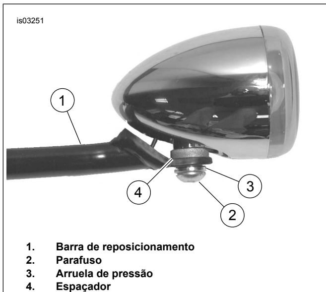
Figura 9. Instale pisca-piscas de 2 3/8 pol.
