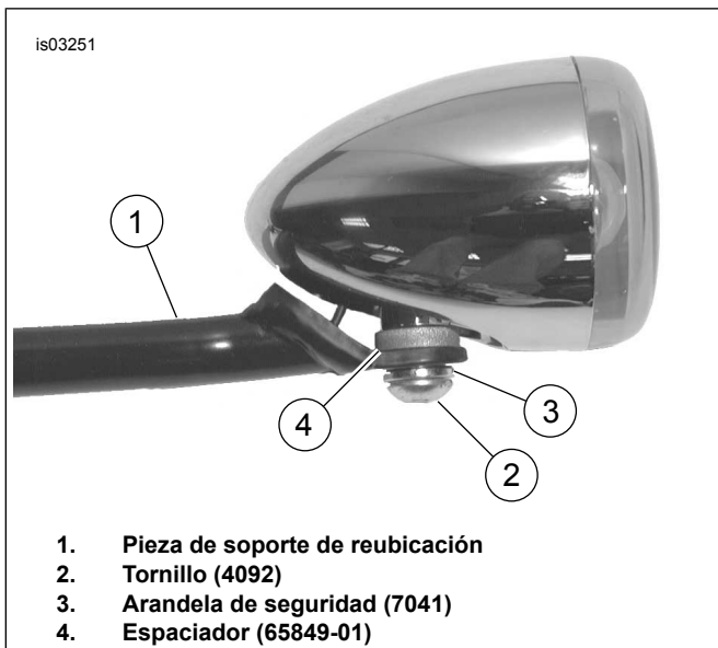
Figura 8. Instalación de señales de giro de 2-3/8 pulg.
