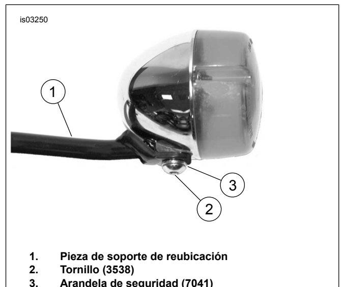
Figura 7. Instalación de señales de giro de 3 pulg.
