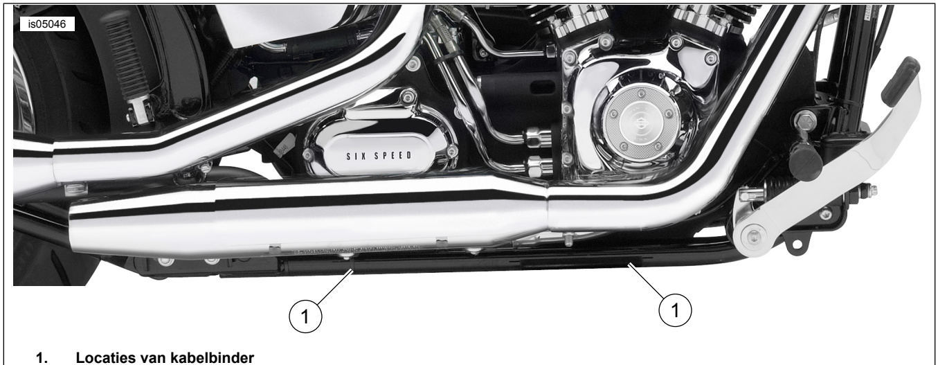
Afbeelding 3. Locatie van kabelbinder
