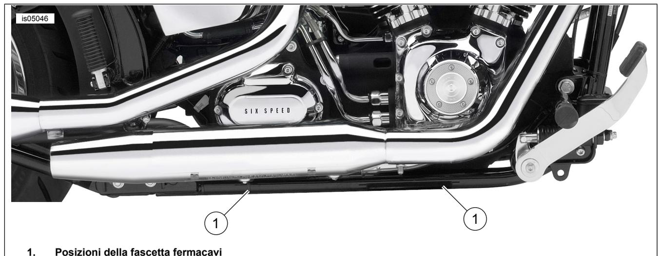
Figura 3. Posizione della fascetta fermacavi
