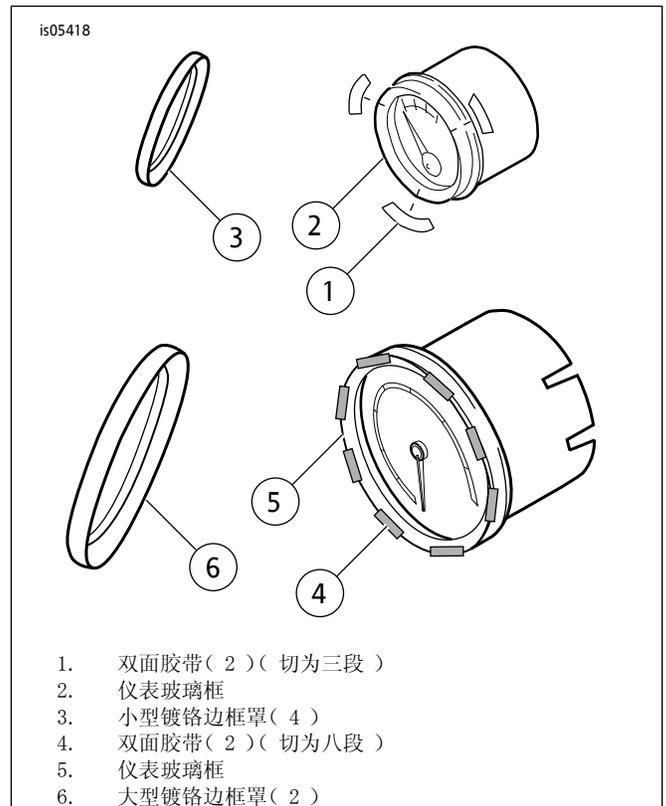
图1. 安装仪表玻璃框
