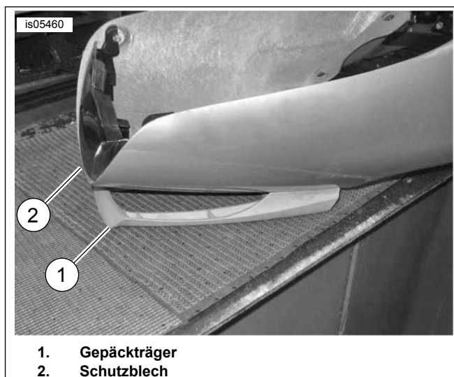
Abbildung 3. Gepäckträger mit Schutzblech ausrichten
