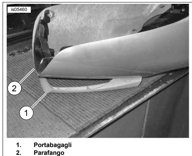
Figura 3. Allineamento del portabagagli e del parafango
