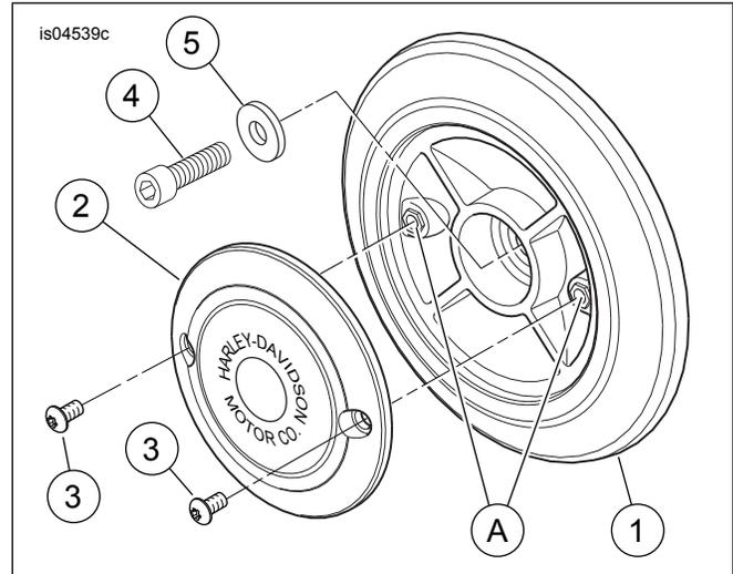
Abbildung 1. Ersatzteile: Luftfilter-Ziersatz
