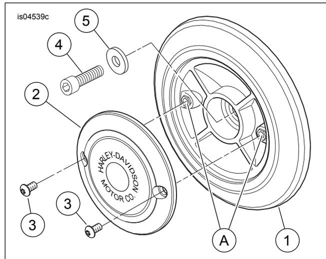
Figura 1. Parti di ricambio: kit finitura del filtro dell'aria
