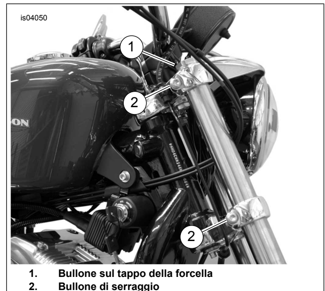
Figura 1. Allentare il bullone di serraggio
