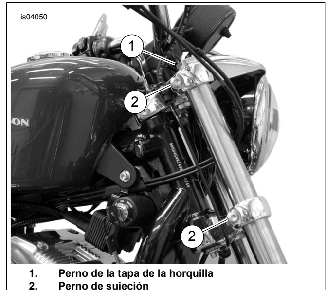
Figura 1. Aflojado del perno de sujeción
