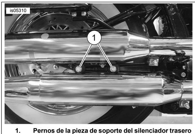
**Figura 4. Pernos de la pieza de soporte del silenciador trasero (se muestra el de 2005)**
