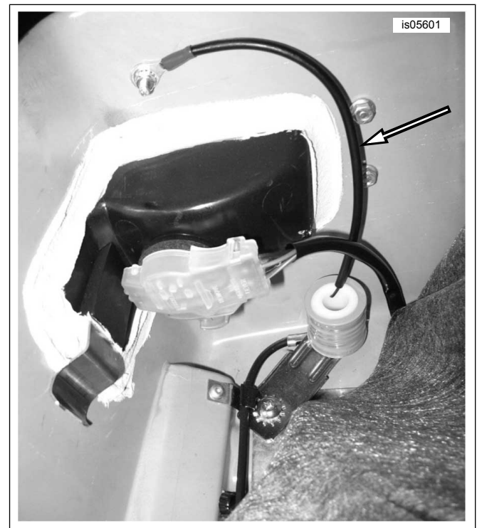
Afbeelding 2. Ligging van de inductiespoelbedrading
