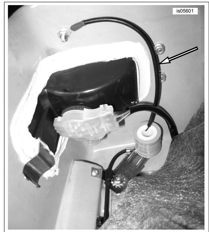
Abbildung 2. Kabelverlegung der CB-Ladespule
