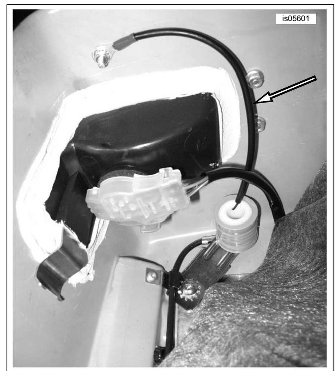
Figura 2. Disposizione del cablaggio della bobina di carico CB
