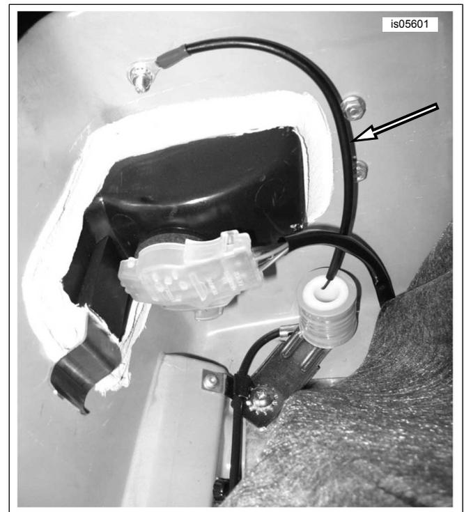
Figura 2. Orientação do fio da bobina de carga do rádio CB
