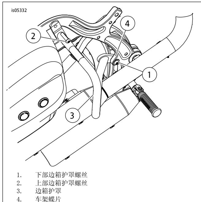
图6。安装边箱护罩- 图示为右侧( 2007年款及之后的车型 )
