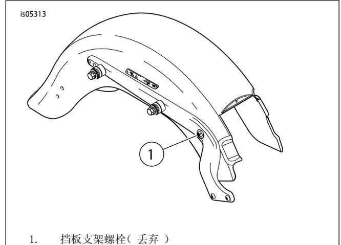
图1. 拆卸对接五金件
