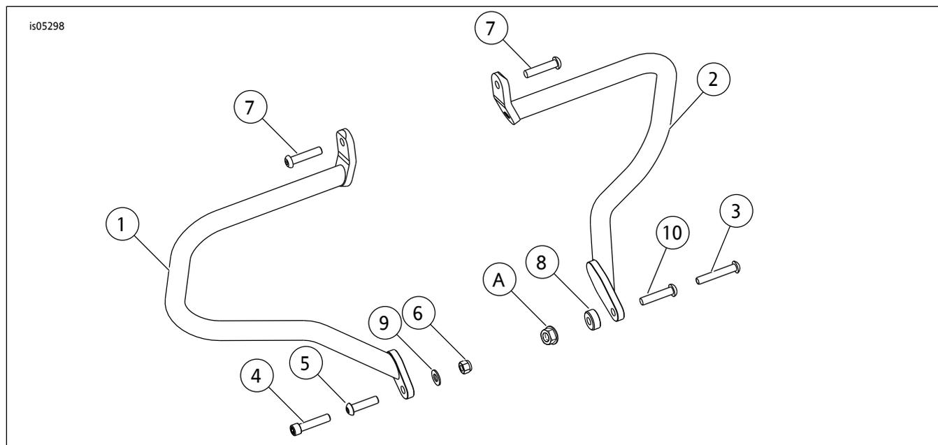
图7。维修零件：边箱护罩套件
