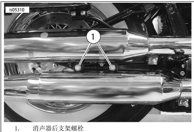
图4。消声器后支架螺栓( 图示为2005年款车型 )
