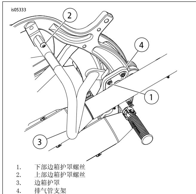
图5。安装边箱护罩- 图示为右侧( 2005年款车型 )
