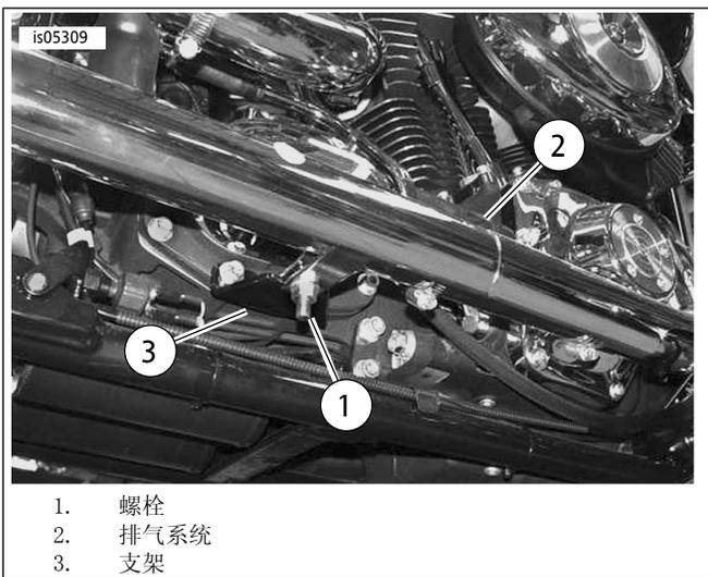
图3。排气系统支架( 图示为2005年款车型 )
