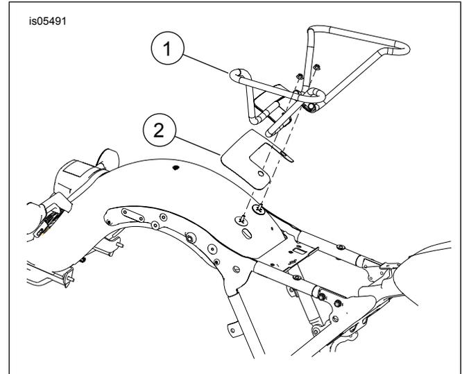
Figure 1. Pièces détachées : Rail de maintien de passager
