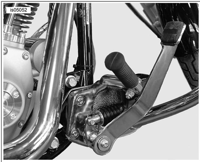
Figura 8. Controles prolongados – Lado direito (tampa de proteção do motor não incluída no kit)
