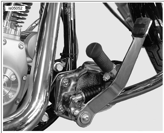
Figura 8. Controles de alcance extendido, lado derecho (en el kit no se incluye el protector del motor)
