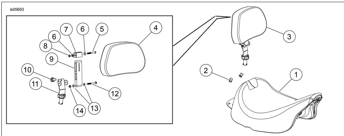
Figura 4. Peças de reposição: Assento Signature com encosto ajustável para o motociclista
