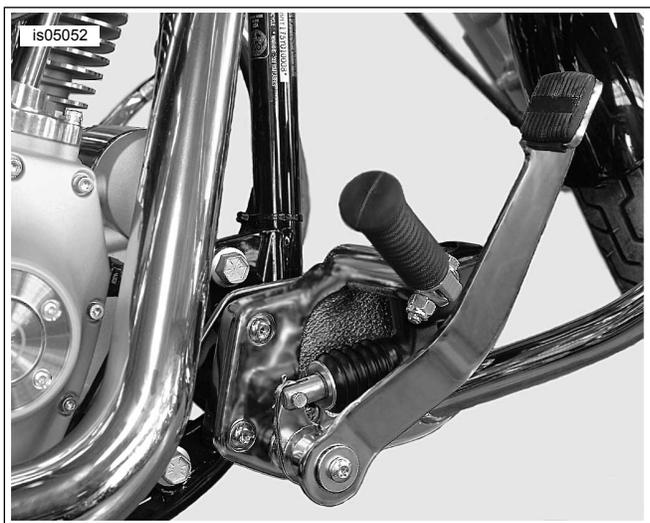
Figure 8. Commande rallongée – côté droit (la protection du moteur non incluse dans le kit)
