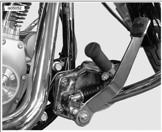
Abbildung 8. Verlängerte Bedienelemente – rechte Seite (Motorschutzbügel ist nicht im Satz enthalten)
