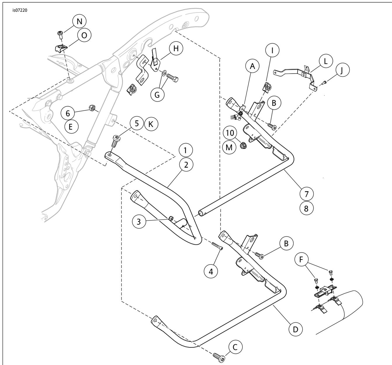
图3。维修零件：边箱护罩套件( 图示为左侧 )
