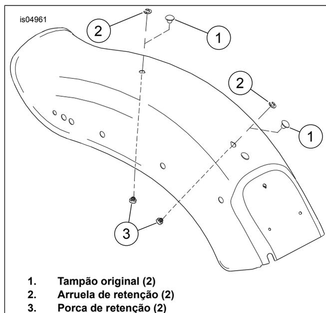
Figura 1. Remoção dos tampões e instalação da porca de retenção
