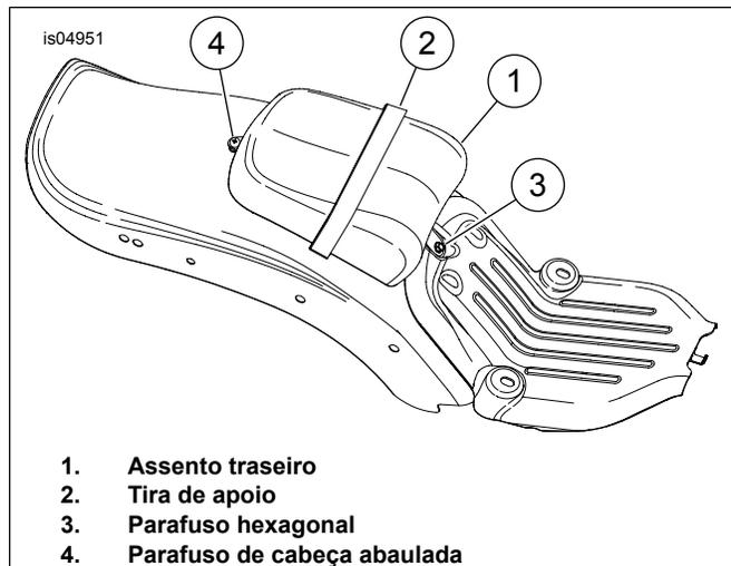
Figura 4. Instalação do assento do passageiro
