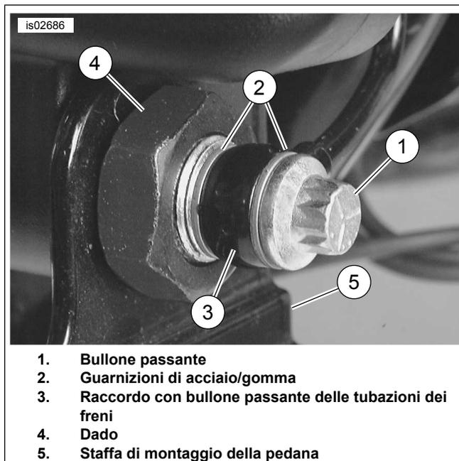
**Figura 3. Attacco del serbatoio del freno posteriore**
