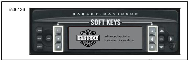
รูปภาพ 2 “ซอฟต์แวร์” คีย์ของตัวรับระบบเสียงขั้นสูง
