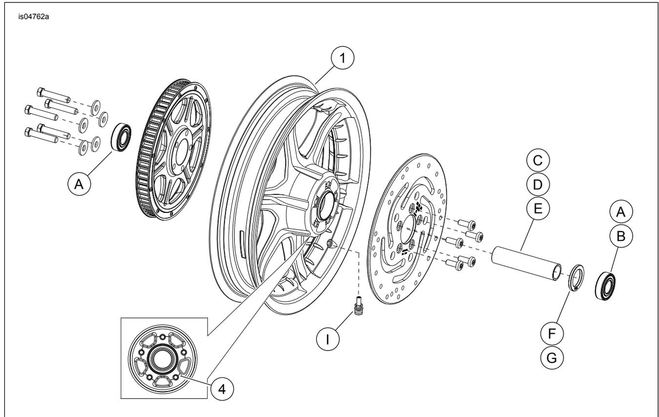
Figura 1. Piezas de servicio: Ruedas traseras ranuradas de seis rayos (se muestra la rueda de 16 pulg.)
