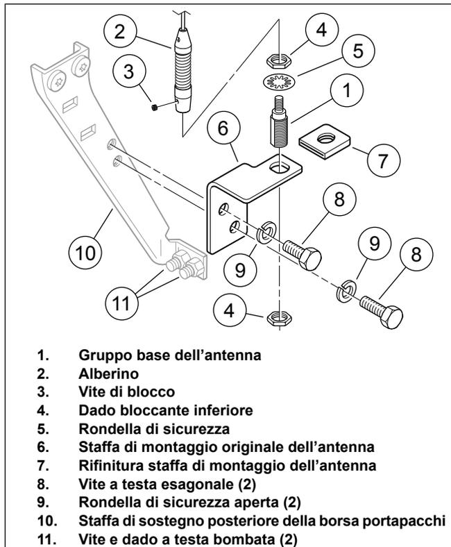
Figura 1. Attacco originale dell'antenna
