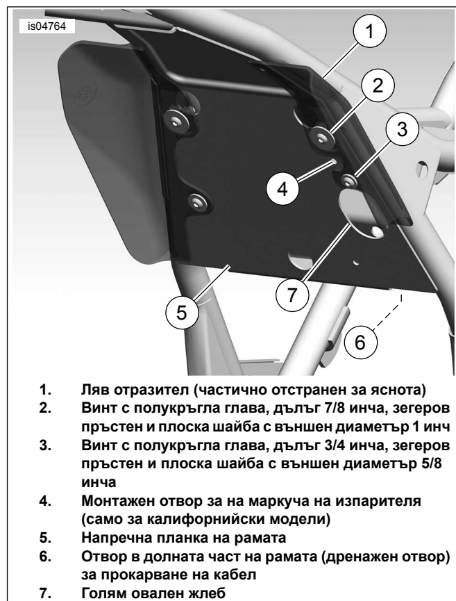
Фигура 5. Модели 2008 г.: Местоположения на стягите - Изглед зад рамата на задния цилиндър (двигателят е отстранен за яснота)
