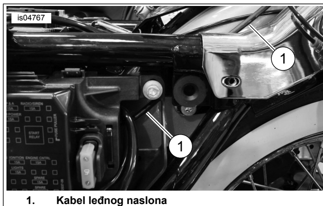
Slika 10. Smjer provlačenja kabela leđnog naslona
