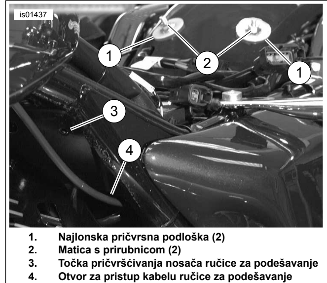
Slika 1. Uklanjanje matice s prirubnicama/lokacija nosača
