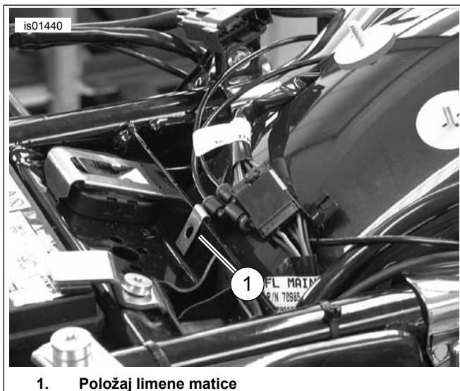
Slika 4. Postavljanje limene matice
