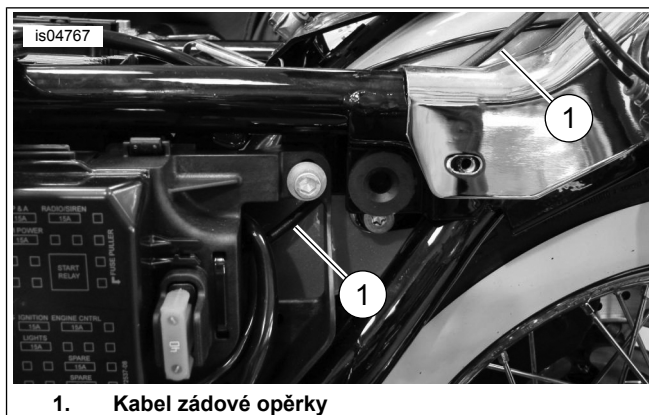
Ilustrace 10. Vedení kabelu zádové opěrky
