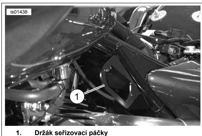
Ilustrace 2. Nainstalovaný držák seřizovací páčky
