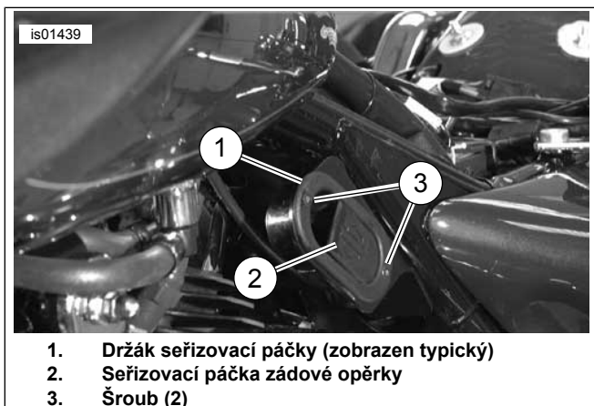
Ilustrace 3. Nainstalovaná seřizovací páčka zádové opěrky
